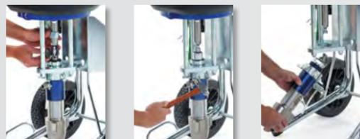
1. Retire el acoplamiento de la varilla, la manguera de entrada y la manguera de pintura
