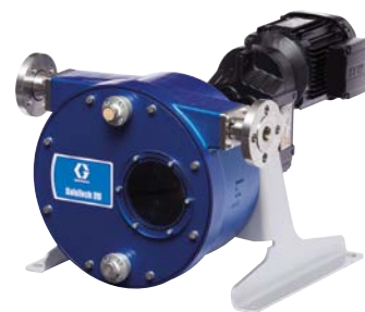
SoloTech 26 Maks. przepływ 37,1 l/min (9,8 gal/min). Stosowane zwykle do transferu materiałów ściernych.
