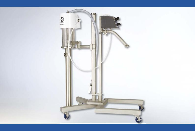
Verwendung im hygienischen Bereich zum Transfer von Flüssigkeiten niedrigerer bis mittlerer Viskosität mit SaniForce-Kolbenpumpen der Art 2:1, 5:1 und 6:1
