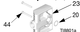
Podrobné zobrazenie vzdialeného výfuku (23)
