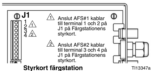
FIG. 18: Service av luftflödesbrytaren
