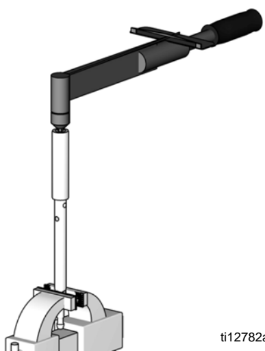
FIG. 2. Ta bort genomflödesmuttern
