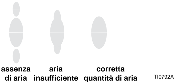
FIG. 8. Problemi di distribuzione della spruzzatura
