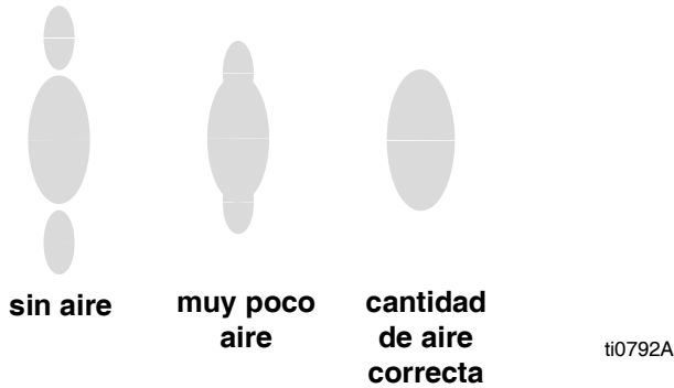
FIG. 7. Problemas del patrón de pulverización
