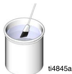
FIG. 15 : Utilisez une brosse à poils doux trempée dans du solvant
