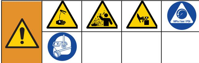
本设备在手动释放压力之前一直处于加压状态。为了防止带压流体造成严重伤害，例如皮肤注射、流体喷射或是部件移动，当您停止作业后，或是在清洁、检查、或是保养设备之前，请遵循泄压流程。
