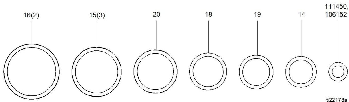
Figure 3 Kit 24T847 e Kit 26A363 dimensioni anello di tenuta
