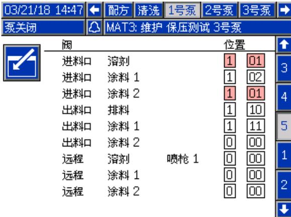
Figure 54 泵屏幕，存在重复的阀门分配
