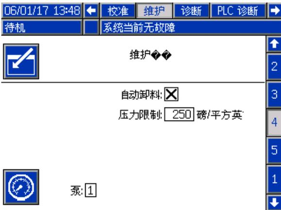
Figure 72 维护屏幕 4，泵手动泄压
