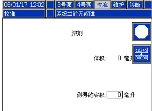
Figure 67 输入测得的溶剂容积
