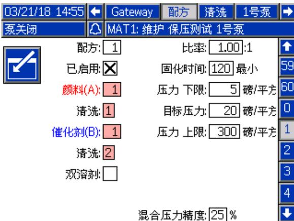
Figure 55 包含无效阀位置的配方屏幕
