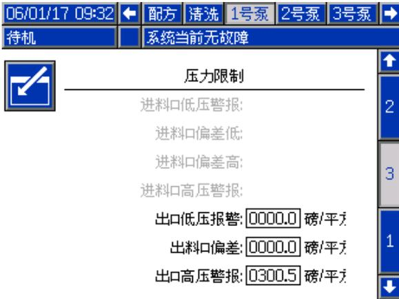
Figure 60 泵屏幕 3，已禁用压力监控
