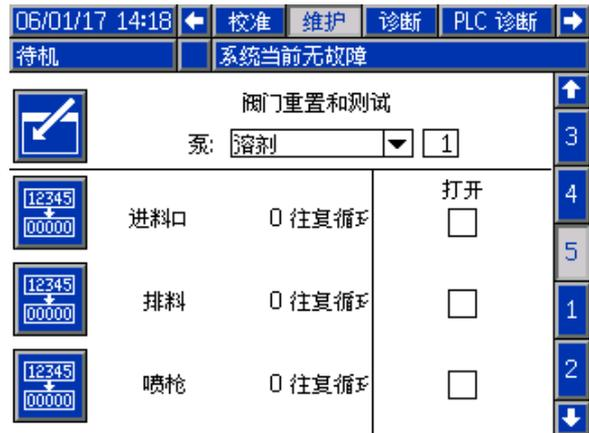
Figure 74 维护屏幕 5，溶剂阀重置
