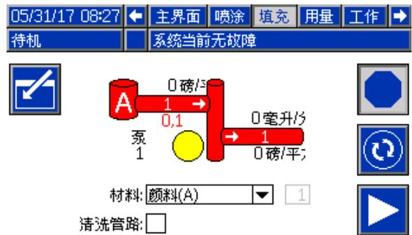
Figure 24 注料屏幕，颜色 (A) 已选定
