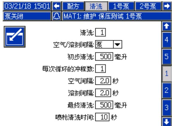
Figure 56 使用泵空气/溶剂间隔的冲洗屏幕
