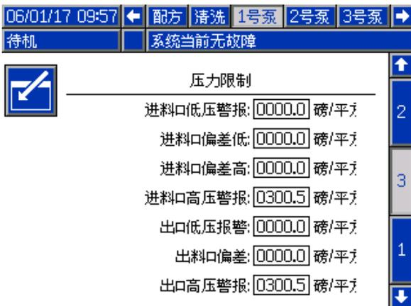
Figure 61 泵屏幕 3，已启用压力监控
