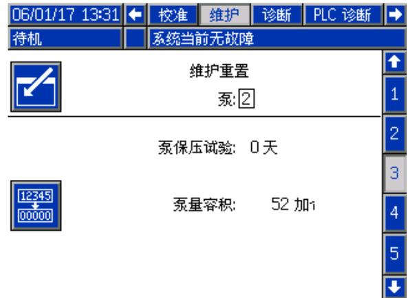
Figure 71 维护屏幕 3，当前泵状态
