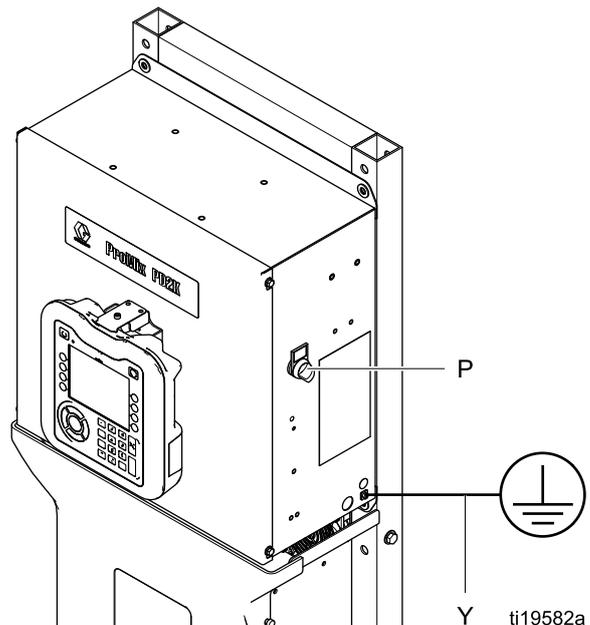
Figure 10 电源开关
