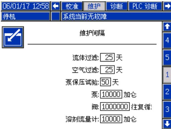
Figure 69 维护屏幕 1，间隔设置
