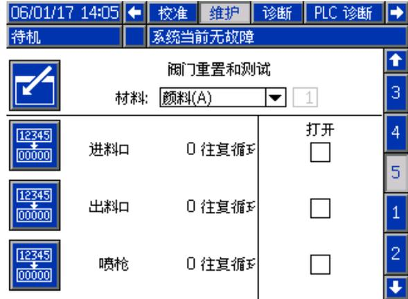
Figure 73 维护屏幕 5，颜色阀重置
