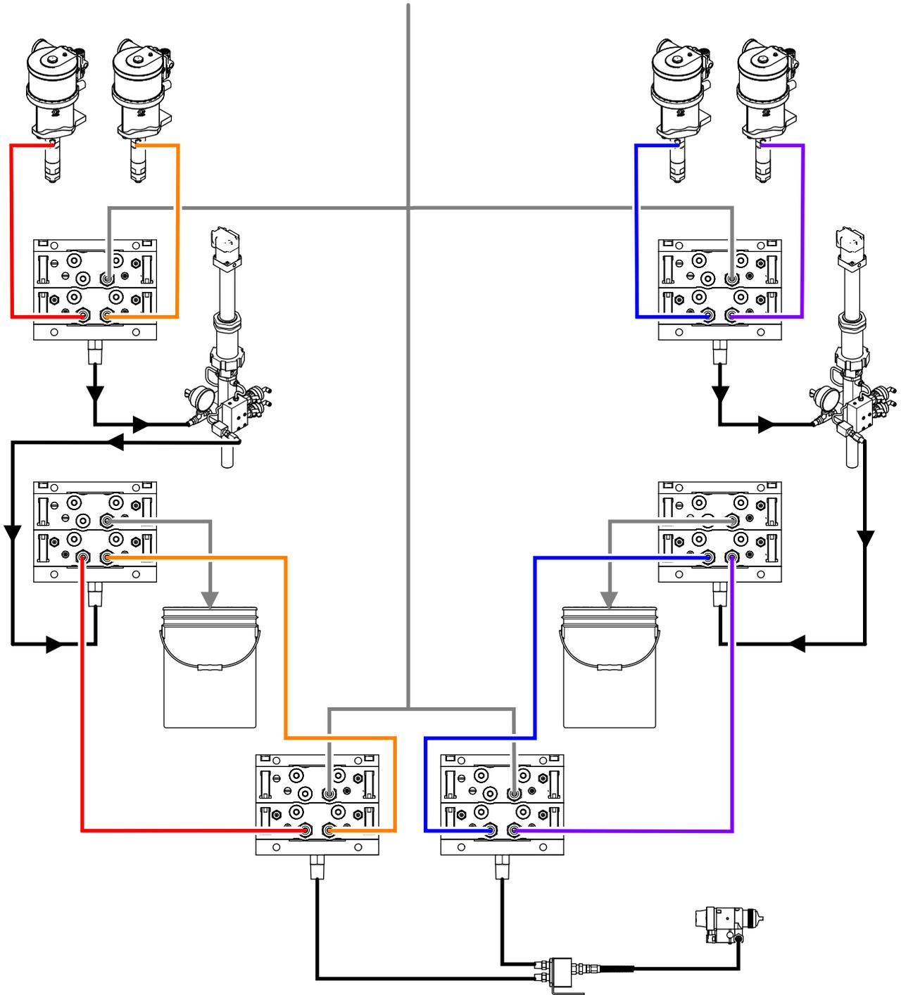
Figure 85 典型 PD2K 自动系统的液体管路。
