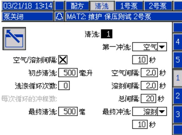
Figure 46 使用空气/溶剂间隔的冲洗屏幕
