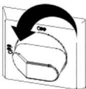
Dadurch wird die gesamte Stromzufuhr zum System über den Netzschalter hinaus unterbrochen.
