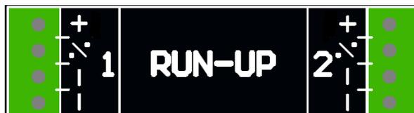
1. Collegare al massimo due regolatori di pressione dell'aria di esecuzione "I/P" o "V/P" per variare la pressione della pompa in base alla velocità di linea. L'hardware rileva automaticamente se è stato collegato un I2P o un V2P.
