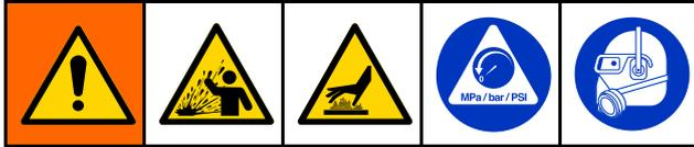
Este equipo permanece presurizado hasta que se libere manualmente la presión. Para evitar lesiones graves por fluido presurizado, como la inyección en la piel, salpicaduras de fluido y piezas en movimiento, siga el Procedimiento de descompresión cuando deje de pulverizar y antes de limpiar, comprobar o realizar mantenimiento al equipo.
