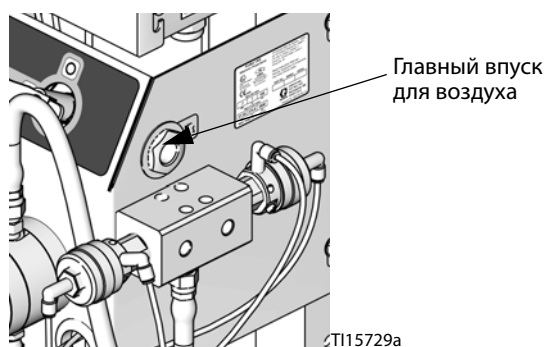
Рис. 3. Подключение главного воздухопровода
