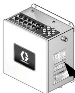
流体ステーション のラベルの配置
