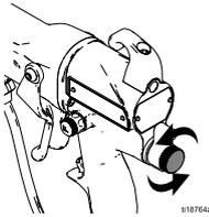
15. Aprire completamente la valvola di limitazione dell'aria di atomizzazione (G) ruotandola in senso orario.
