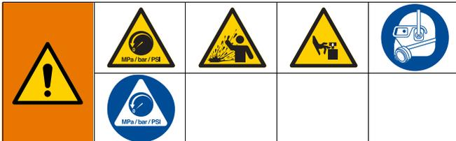
Este equipo seguirá presurizado hasta que se libere manualmente la presión. Para ayudar a evitar lesiones graves por salpicaduras de fluido y las ocasionadas por piezas en movimiento, siga el Procedimiento de descompresión cuando deje de pulverizar y antes de limpiar, revisar o dar servicio al equipo.
