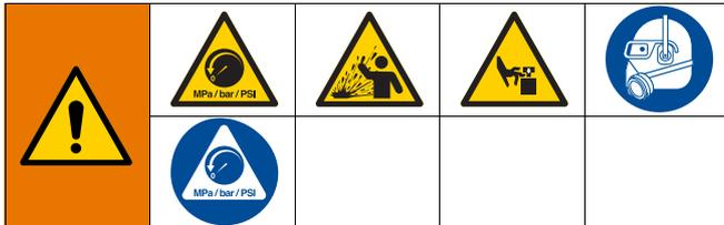
Dieses Gerät bleibt unter Druck, bis der Druck manuell entlastet wird. Um ernsthafte Verletzungen durch Verschütten von Material und durch bewegliche Teile zu vermeiden, das Verfahren zur Druckentspannung nach Abschluss des Spritzvorgangs sowie vor der Reinigung, Prüfung oder Wartung des Geräts befolgen.
