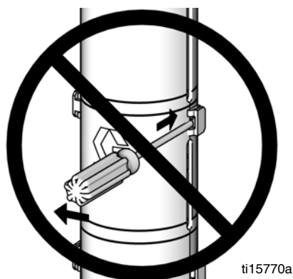
AFB. 4. Het spatscherm demonteren
