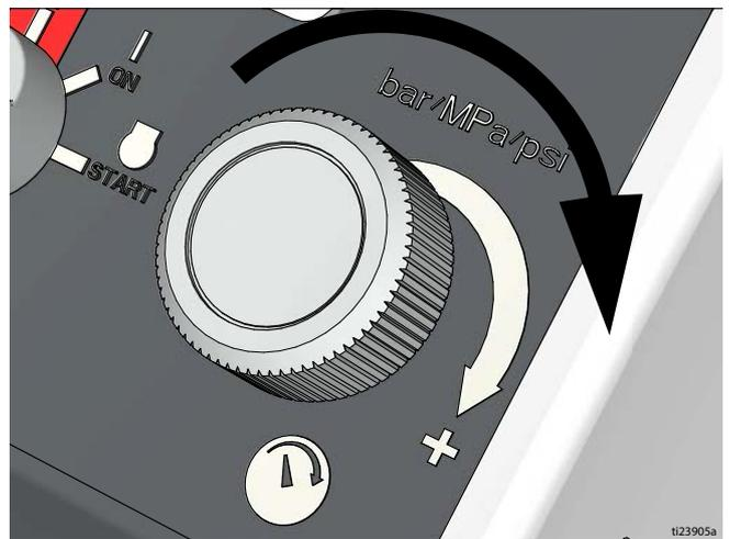
5. Ruotare la regolazione della pressione della pompa idraulica in senso orario finché non sono posizionate, quindi in senso antiorario di 1/6 di giro.
