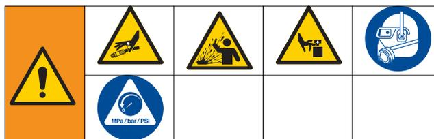
L'apparecchiatura rimane pressurizzata finché la pressione non viene rilasciata manualmente. Per evitare lesioni serie causate dal fluido pressurizzato, ad esempio iniezioni nella pelle, da schizzi di fluido e da parti in movimento, seguire la procedura di rilascio pressione quando si smette di spruzzare e prima di pulire, verificare o eseguire la manutenzione dell'apparecchiatura.
