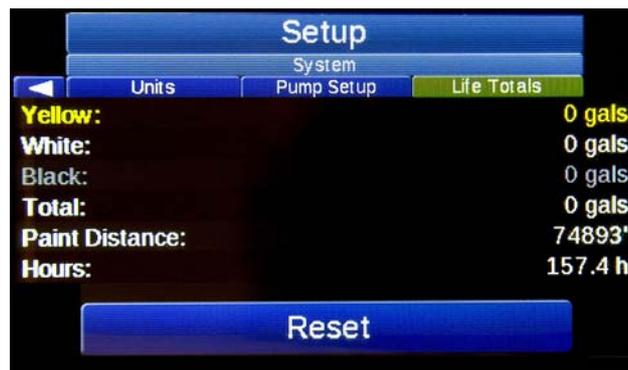
La scheda Life Totals (Totali durata) fornisce il numero totale di distanza coperta e litri pompati per ogni colore. Questo numero permane anche dopo l'azzeramento dei canali contatori. Lo scopo principale dei totali relativi alla durata è permettere all'operatore di sapere quando sottoporre a manutenzione le pompe e altre apparecchiature.
