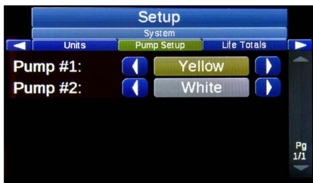
Inserire con quale colore è configurata ogni pompa. È un'operazione necessaria per la corretta registrazione dei dati relativi ai litri pompati.
