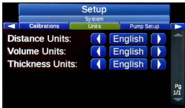
Regolare l'unità di misura per distanza, volume e spessore scegliendo tra unità inglesi e metriche.
