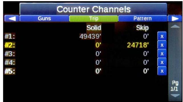
I canali contatori di attivazione rapida agiscono come un contachilometri di un veicolo. È possibile azzerare qualsiasi contatore di attivazione rapida singolarmente, ma i contatori normali delle pistole non vengono alterati, conservando in tal modo distanze percorse e ritmo di applicazione. Questa funzione può essere utile per il monitoraggio di una sottosezione di un lavoro.
