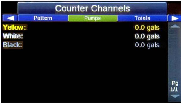
Il canale contatore relativo alle pompe tiene traccia dei litri pompati per ogni colore. Le pompe devono essere configurate con il colore corretto nel menu Setup/System/Pump Setup (Configurazione/Sistema/Configurazione pompe).
