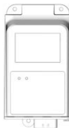
図 5 : 潤滑コントローラーのコネクター
