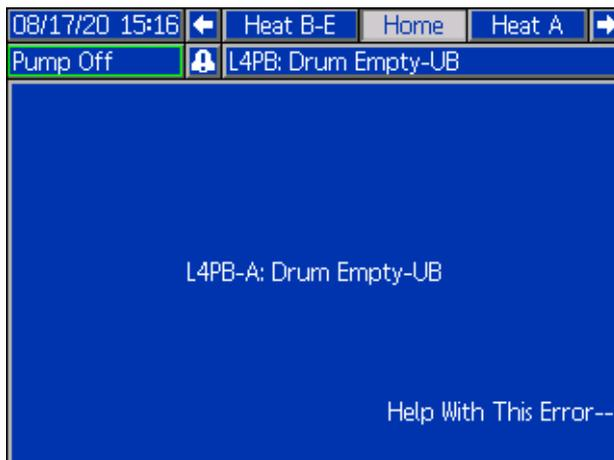
2. Verrà visualizzata la schermata del codice QR. Fare la scansione del codice QR con lo smartphone per inviarlo direttamente alla ricerca e risoluzione guasti online per il codice di errore attivo.
