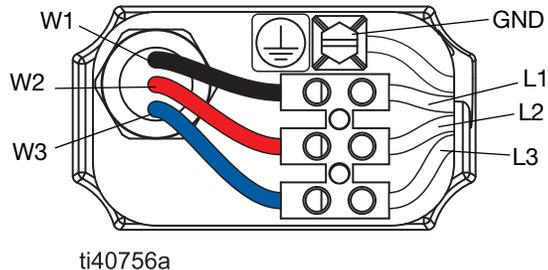
**FIG. 7 Motor wiring**
