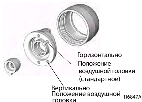
Рис. 11: Положения установочного штифта воздушной головки
