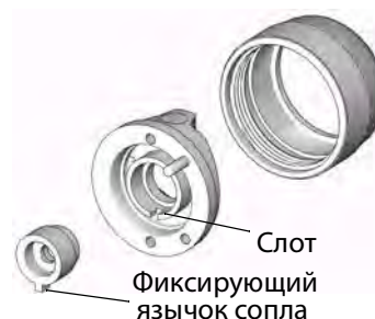
Рис. 7: Установка сопла и воздушной головки
